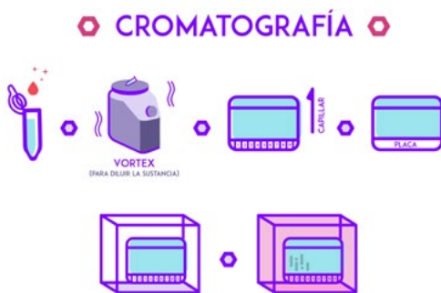
Figura 2. Esquema del proceso de cromatografía en capa fina
