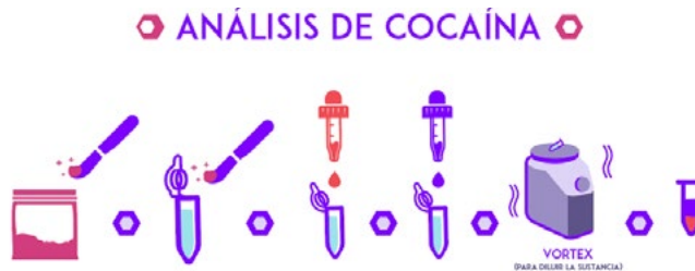
Figura 4. Esquema del proceso de análisis semi-cuantitativo por precipitado de cocaína
